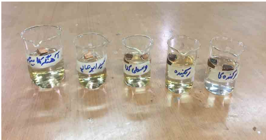
تصویر ۴: غوطه‌وری نمونه‌های چوبی استخراج‌شده از سقانفارها در آب مقطر و طلائی شدن آب در برخی از آن‌ها (نگارندگان، ۱۴۰۰). Fig. 4: Immersion of wooden samples taken from Saqanefars in distilled water and turning the water to golden color in some of them (Authors, 2020).
