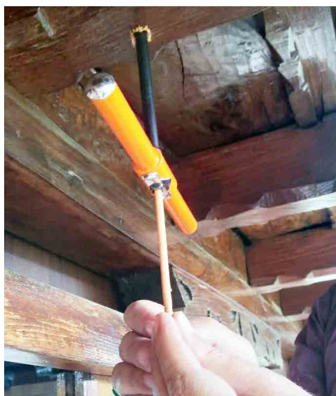
تصویر ۳: نمونه برداری غیرمخرب از ستون چوبی سقانفار با استفاده از متنه رویش سنج (نگارندگان، ۱۴۰۰). Fig. 3. Non-destructive sampling of Saqanefar wooden pole using an increment borer (Authors, 2020).
